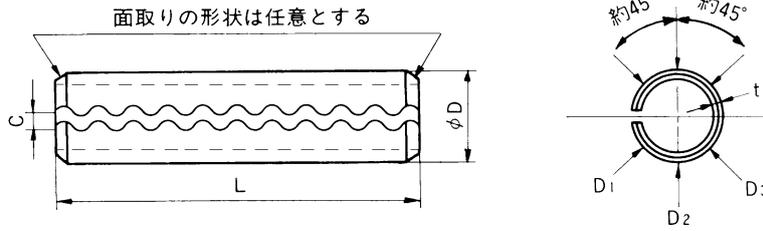
すきまCは、スプリングピンを適用する穴に挿入したとき、辺が接触しないような寸法でなければならない。(但し、両端部を除く。)
